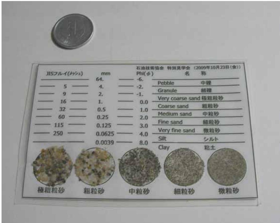
**写真13:** 参加者全員に配られた粒度表。両面テープを皮ポンチで丸くりぬいた物に予め用意しておいた砂粒を貼り付け、台紙に貼る。最後にパウチして仕上げる。
