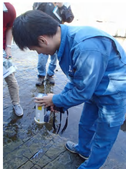
写真 6 レーザーガス検知器による メタンガス-コラム濃度の測定
