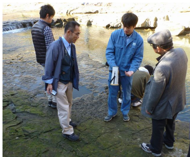
写真 10 レーザー測定器によるメタンガス濃度測定の試み。（Stop 3）
