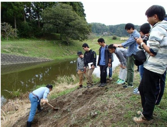
写真 10 瑞沢川の土手を掘出し、メタンガスを湧出する土の特徴を観察。
