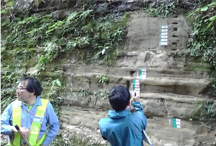
写真 21 砂層を対象にした粒度分析結果について質問に答える案内者の1人の岩本 (Stop 5)。砂層の横には、フルイを用いた粒度分析結果が、試料を採取した順番に上下に配列してある (Stop 5)
